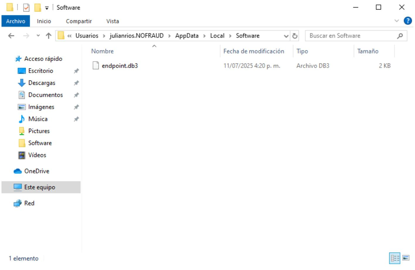
En este archivo se almacena configuración como la dirección del servidor, las llaves de cifrado para la comunicación con la consola central y otra información relevante para su funcionamiento.
